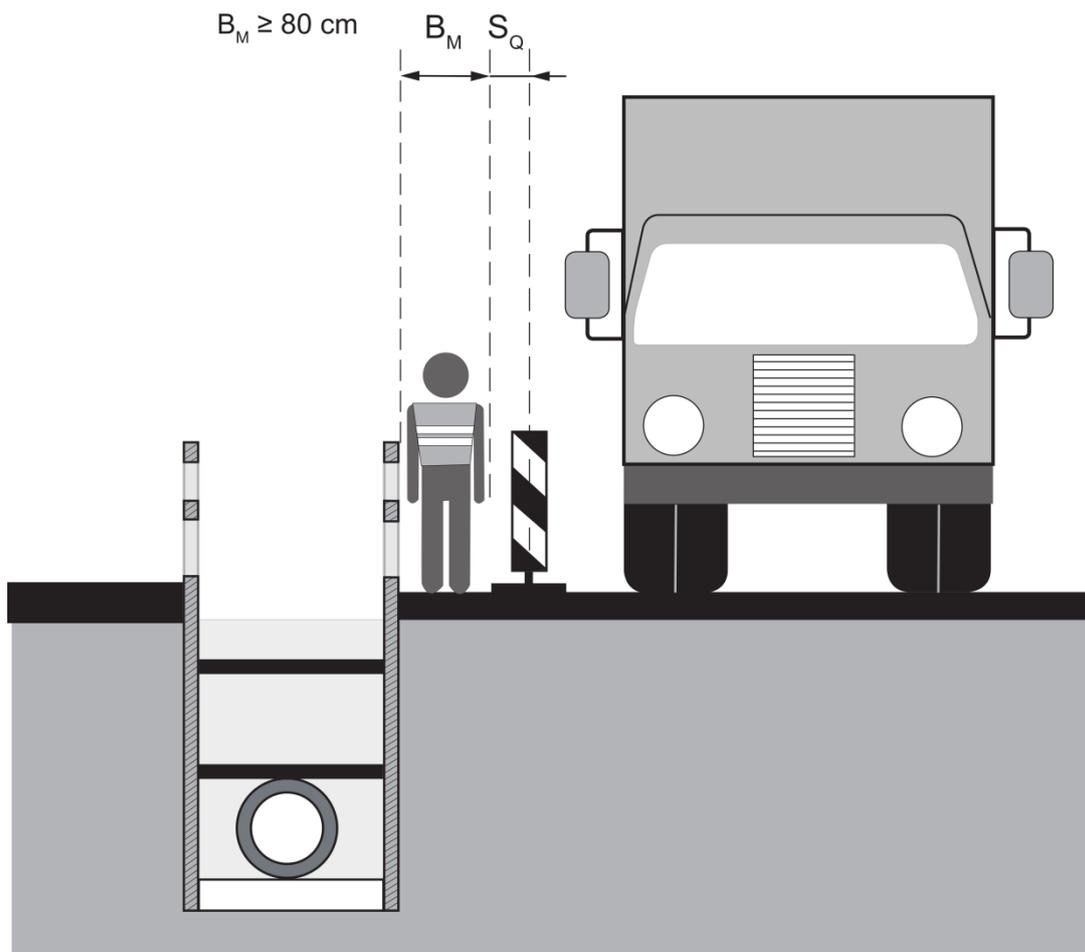
Abb. 6: Seitlicher Sicherheitsabstand ( $S_Q$ ) und Mindestbreite ( $B_M$ ) für Arbeitsplätze und Verkehrswege auf Straßenbaustellen, Beispiel Kanalgrabenherstellung
