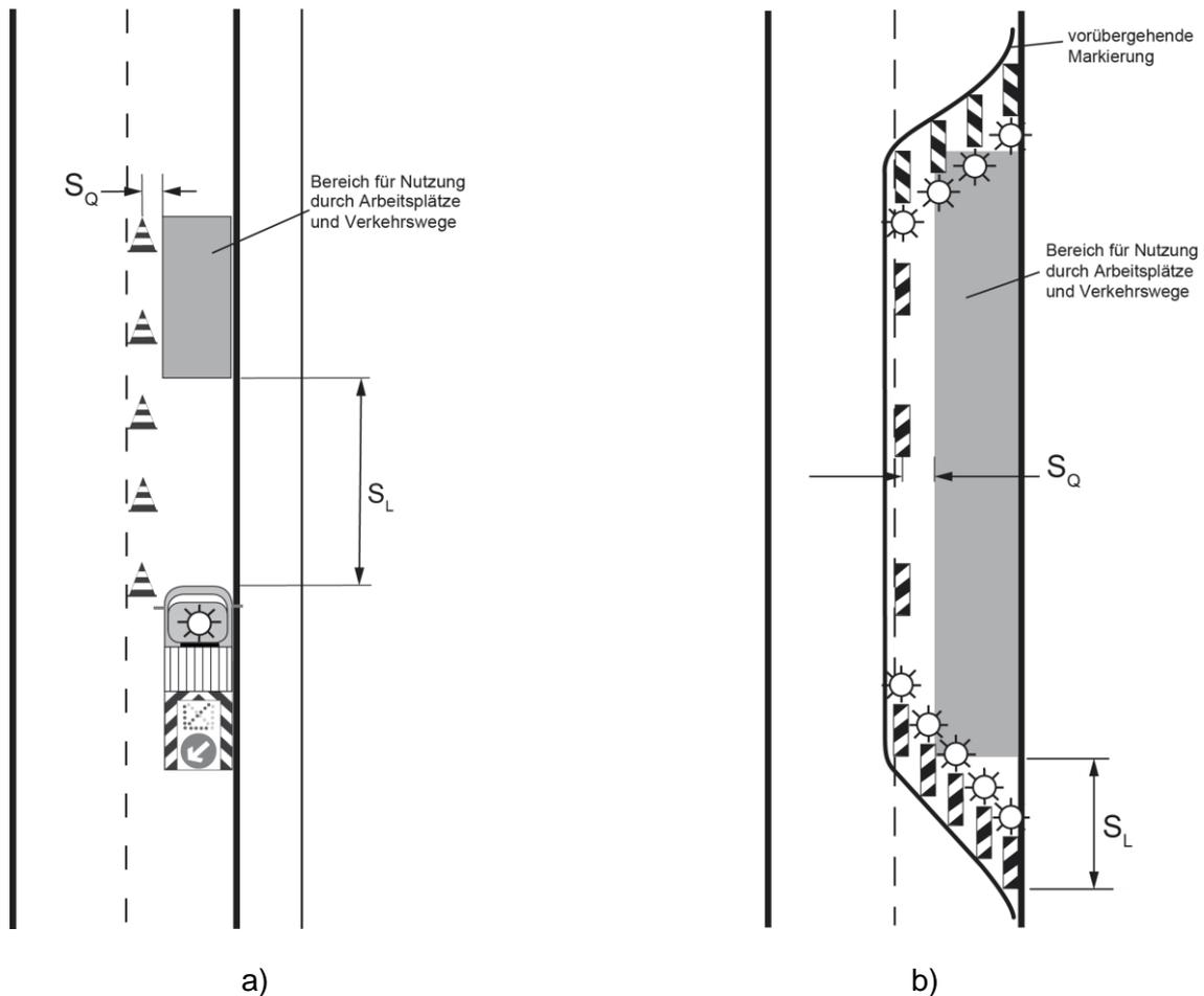
Abb. 7: Sicherheitsabstand ( $S_L$ ) zum ankommenden Verkehr am Beispiel
