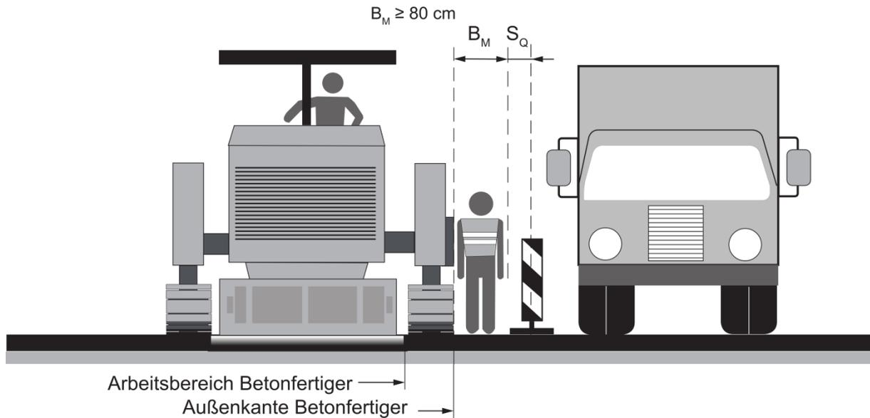
Abb. 5: Seitlicher Sicherheitsabstand ( $S_Q$ ) und Mindestbreite ( $B_M$ ) für Arbeitsplätze und Verkehrswege auf Straßenbaustellen, Beispiel Beton-/Gussasphaltfertiger mit überkragendem Kettenlaufwerk
